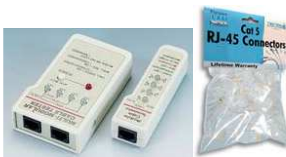
Un tipo di tester per cavi RJ45 ed una busta di connettori RJ45.
